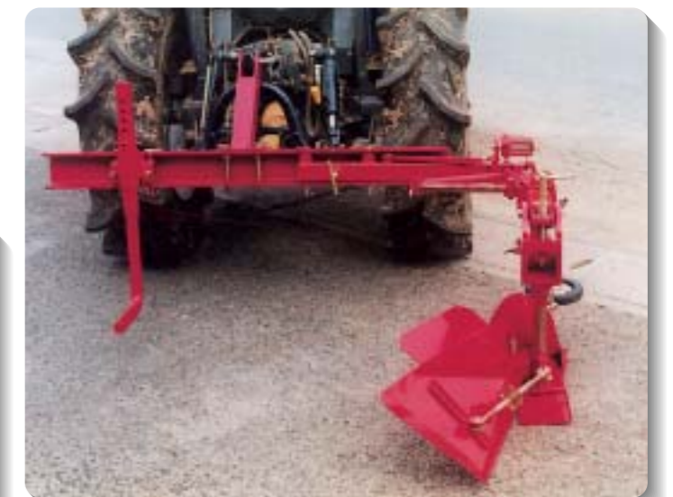
尾ソリセット 尾ソリは、ヒッチ部の水平保持に有効です。(通常はオプション設定)
